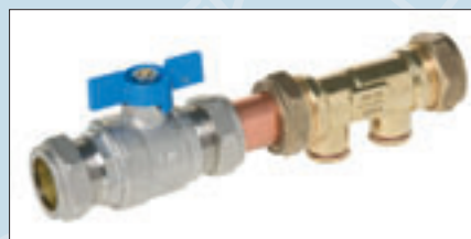
2. Een terugstroombeveiligingseenheid bestaat uit het terugstroombeveiligingstoestel (appendage rechts met de keerklep) en extra randapparatuur als controlenokken (hier geïntegreerd) en afsluiters (appendage links)
