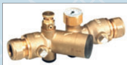
3. Controleerbare terugstroombeveiligingseenheid EA. Van links naar rechts, kogelkraan, testnokken, keerklep, manometer, service-afsluiter voor zowel uitvoering van de standaardmethode als het verwisselen van de keerklep.
